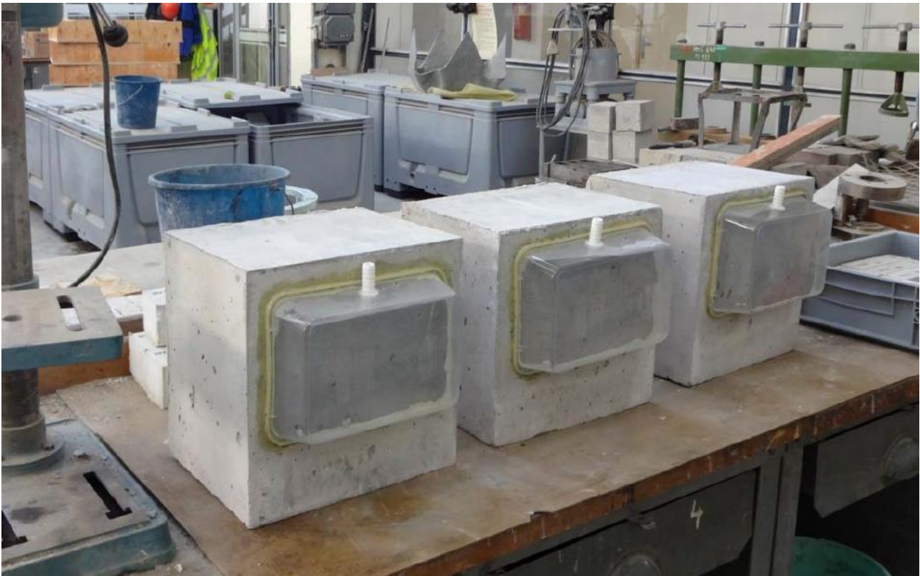
Kuva 2. Vesisäiliöt asennettuna testikappaleiden pintaan.
