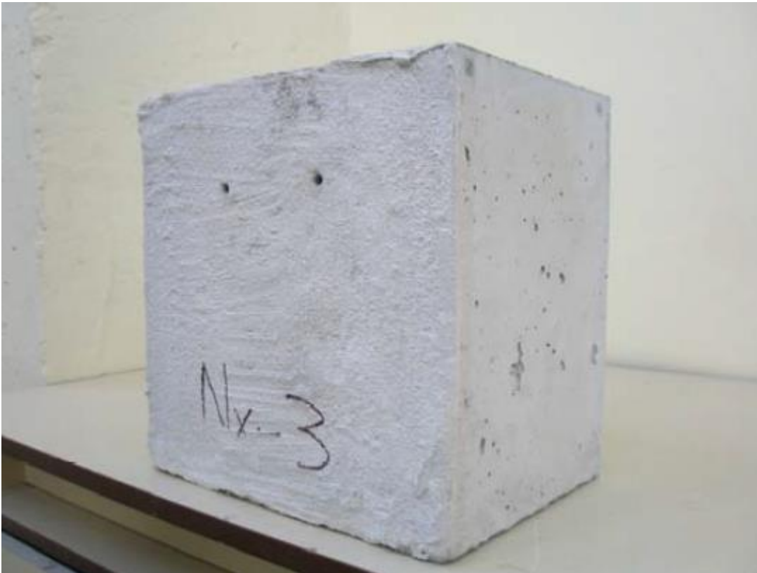
Kuva 1. C20/25 Testikappale jossa Xypex Concentrate sively
