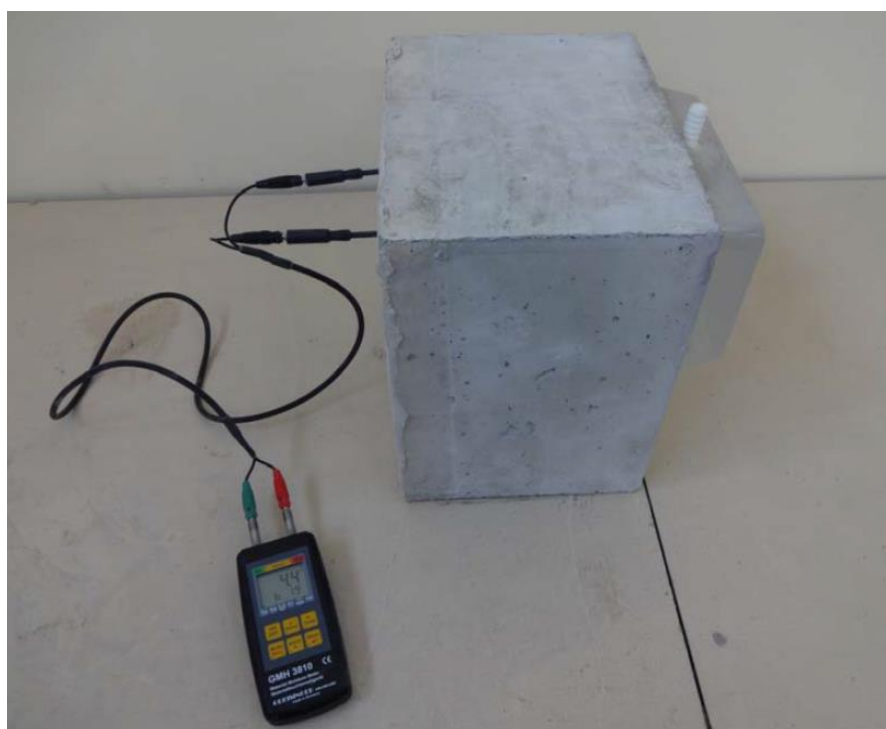
Kuva 4. Kosteuden mittaaminen Xypex Concentrate käsitellystä kappaleesta
