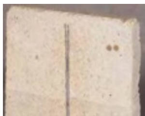
Kahden AQUAFIN-CJ5-levyn liitoskohta halkaistussa kappaleessa.
